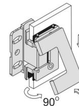
Band mit Glasscheibe um 90° drehen, Abdeckkappe auf Gegenplatte klipsen (Klipsen mit Federzug).
