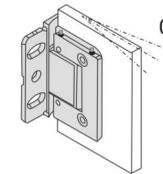
Ausrichten des Beschlages (lotrechte Ausrichtung). Die Gegenplatte montieren, mit 10 Nm anziehen.
