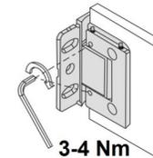
Nulllage einstellen, Glas justieren. Die Schraube für Nulllage mit 3-4 Nm anziehen.
