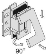
Entfernen Sie die Zwischenlagen. Um die Abdeckkappen der Gegenplatte zu lösen, drehen Sie das Band um 90°. Nehmen Sie die Abdeckkappen lt. Skizze ab.
