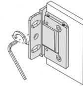
Die Gegenplatte lösen. Das Glas montieren. Bitte beachten, beidseitig symmetrisch die Zwischenlagen montieren:
